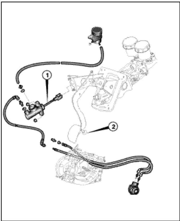
① Réglage de la tige de poussée de la pompe d'embrayage:
